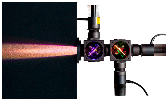
図 2. ケージで構成した 3 色 LED 照明装置。
